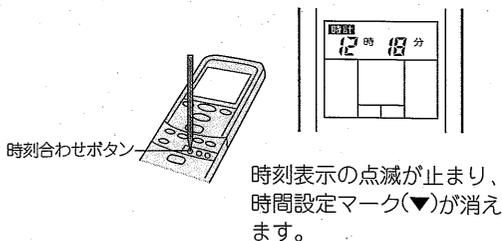
時刻表示の点滅が止まり、時間設定マーク(▼)が消えます。
